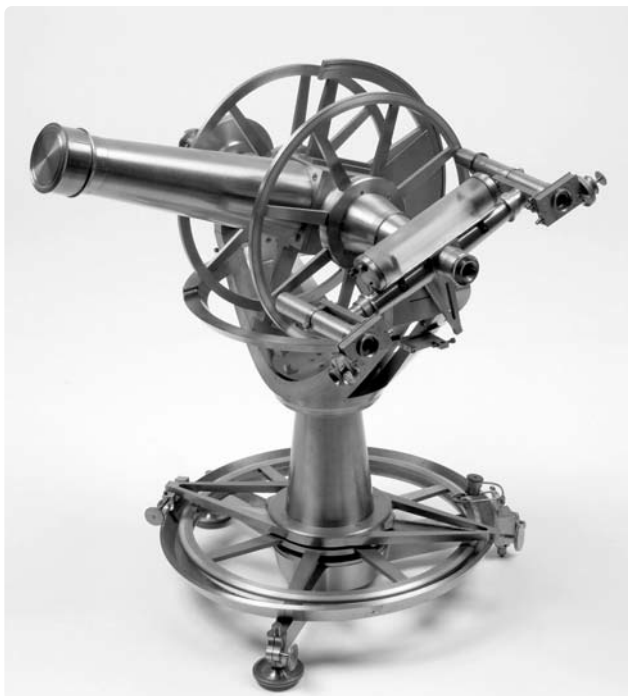
Links: Theodoliet van Troughton & Simms uit London, vanaf 1832 gebruikt als transit-instrument, na aanpassingen door de Amsterdamse instrumentmaker E. Wenckebach. Rechts: Universeel instrument van Utzschneider & Fraunhofer uit München, aangeschaft in 1838.
